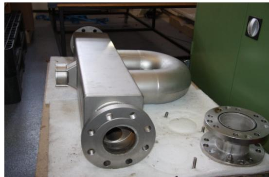
**Figure 4:** Coriolis meter (**Meter #2**)
