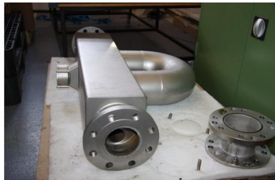
**Figure 4:** Coriolis meter (Meter #2)
