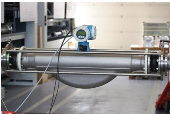
**Figure 5:** Coriolis meter (Meter #3)
